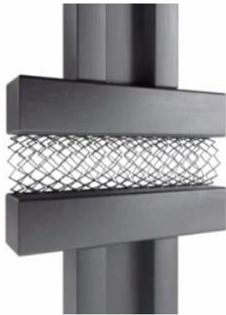
El stent comprimido entre dos placas paralelas.
